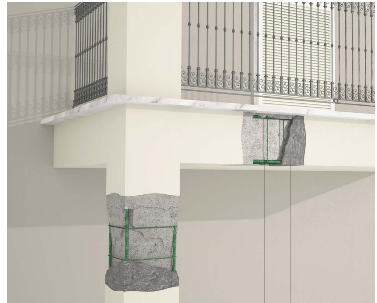
FASE 1 PASSIMIX - Applicazione della boiacca passivante
